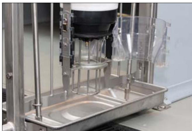
TUBE-O-MAT® VI+ auge et partie dosage
